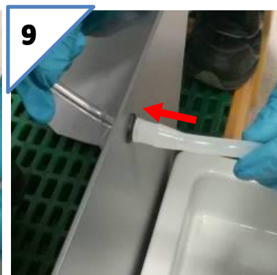
9 Retirer le clamp et mettre en place la tubulure dans son emplacement
